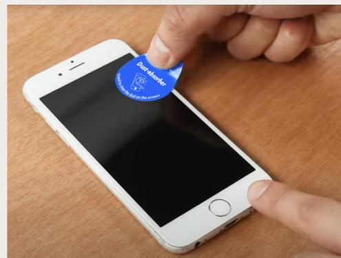
*Le « dust-absorber » permet d'éliminer les poussières rebelles d'un smartphone avant la pose d'un écran de protection.*
